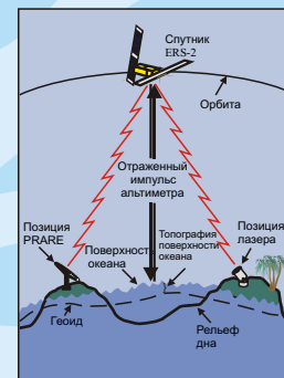
Схематическое изображение спутниковой системы наблюдений над уровнем моря
